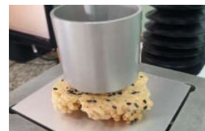
ภาพหัววัด P/๕๐ สำหรับวัดค่าความแข็งผลิตภัณฑ์ข้าวแต่น้ำนางา แบรินด์แสงตะวัน
